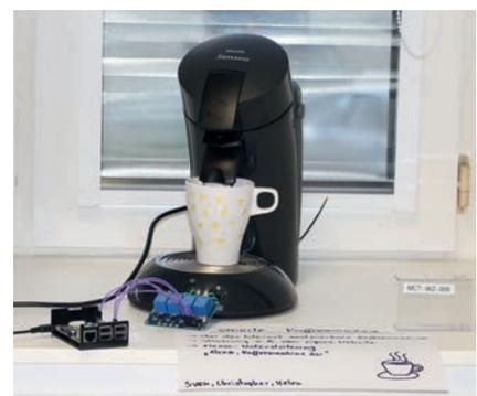
Kaffeemaschine: Die Kaffeemaschine lässt sich mit Sprachkommandos steuern. Dafür setzen die Studierenden die Digi Box und einen Sprachassistenten ein.
