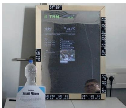
Wie wird das Wetter? Stehe ich auf dem Weg zur Arbeit im Stau? Dies und mehr beantwortet der Smart Spiegel. Für die Anzeigensteuerung kam die Digi Box zum Einsatz.
