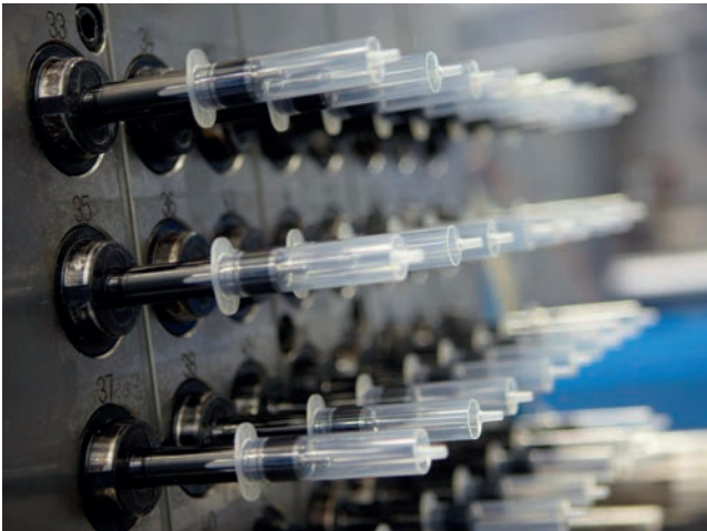
Blick in eine Spritzgussmaschine: Werkzeug mit Spritzenzylindern
