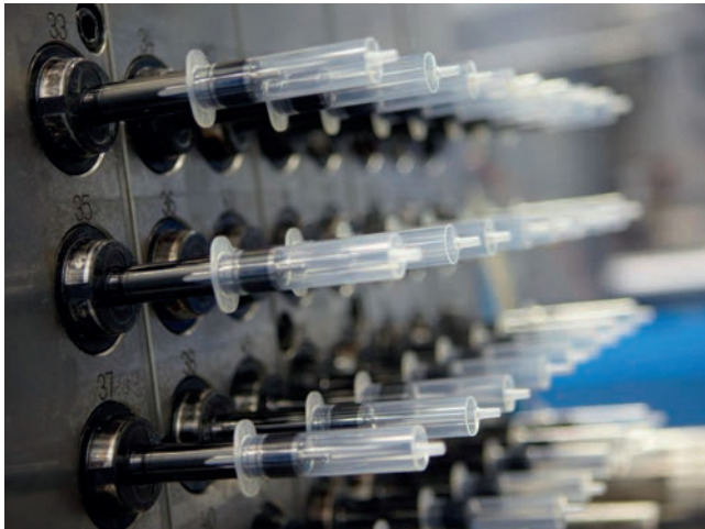
Blick in eine Spritzgussmaschine: Werkzeug mit Spritzenzylindern
